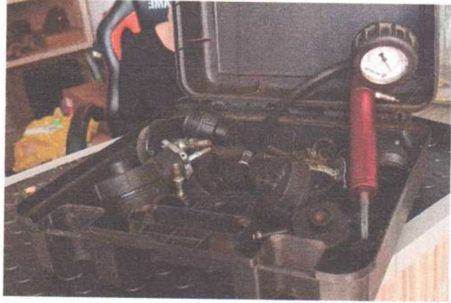
Medidor de pressão do sistema de Arrefecimento :
